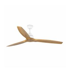
Ventilador de techo de líneas modernas ideal para estancias más grandes de 17,6m2. Fabricado en acero, palas de madera y difusor de cristal opal. Accionado por mando a distancia (incluido). Este ventilador blanco tiene función inversa y es apto para techos inclinados. Dispone de 3 velocidades regulables con un consumo de 14 - 30 - 56W y 80 - 113 - 155 revoluciones por minuto según velocidad. Caudal de aire: 129.29 m3 min / 4564 CFM.
